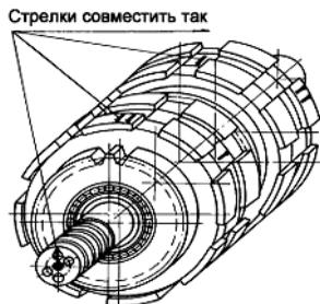
**Рис. 58. Установка гидроподжимных муфт**
