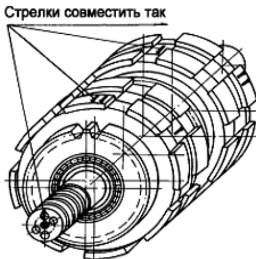
Рисунок 61 - Установка гидроподжимных муфт
