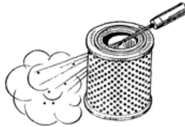
Рисунок 23 - Продувка фильтрующего элемента
