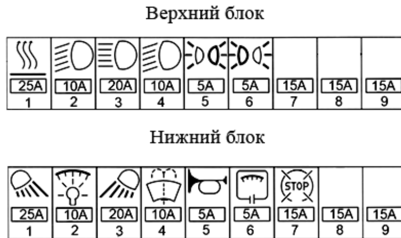
Рисунок 43 – Схема размещения предохранителей
