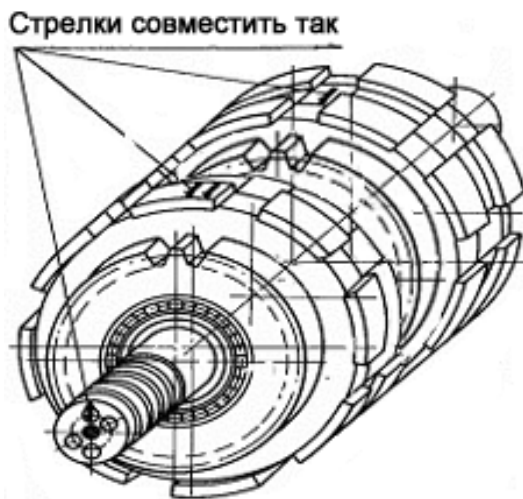
Рисунок 59 – Установка гидropоджимных муфт
